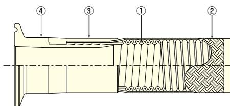
フェルールとフッ素樹脂チューブは、加締めにて固定されています。
