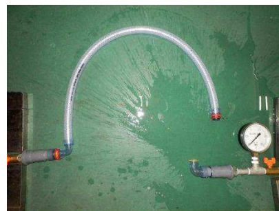
写真 3-試験体①破壊状況
