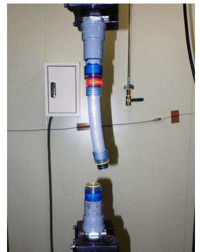
写真 14-試験体①破壊状況
