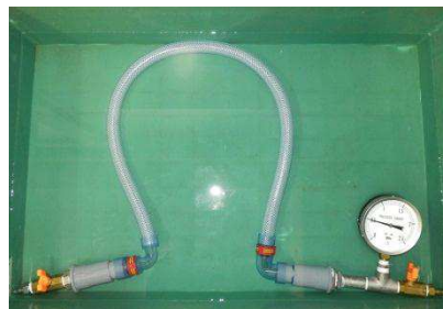
写真 1-気密試験状況
