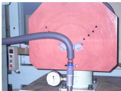
写真 4-曲げ試験状況 (ホース部)
