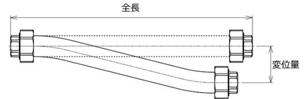
② ユニオンナットを手締めできる山数までねじ込み、チューブ本体にねじれが生じないようにパイプレンチ等でユニオンネジを固定して、ユニオンナットを締め付けて下さい。
